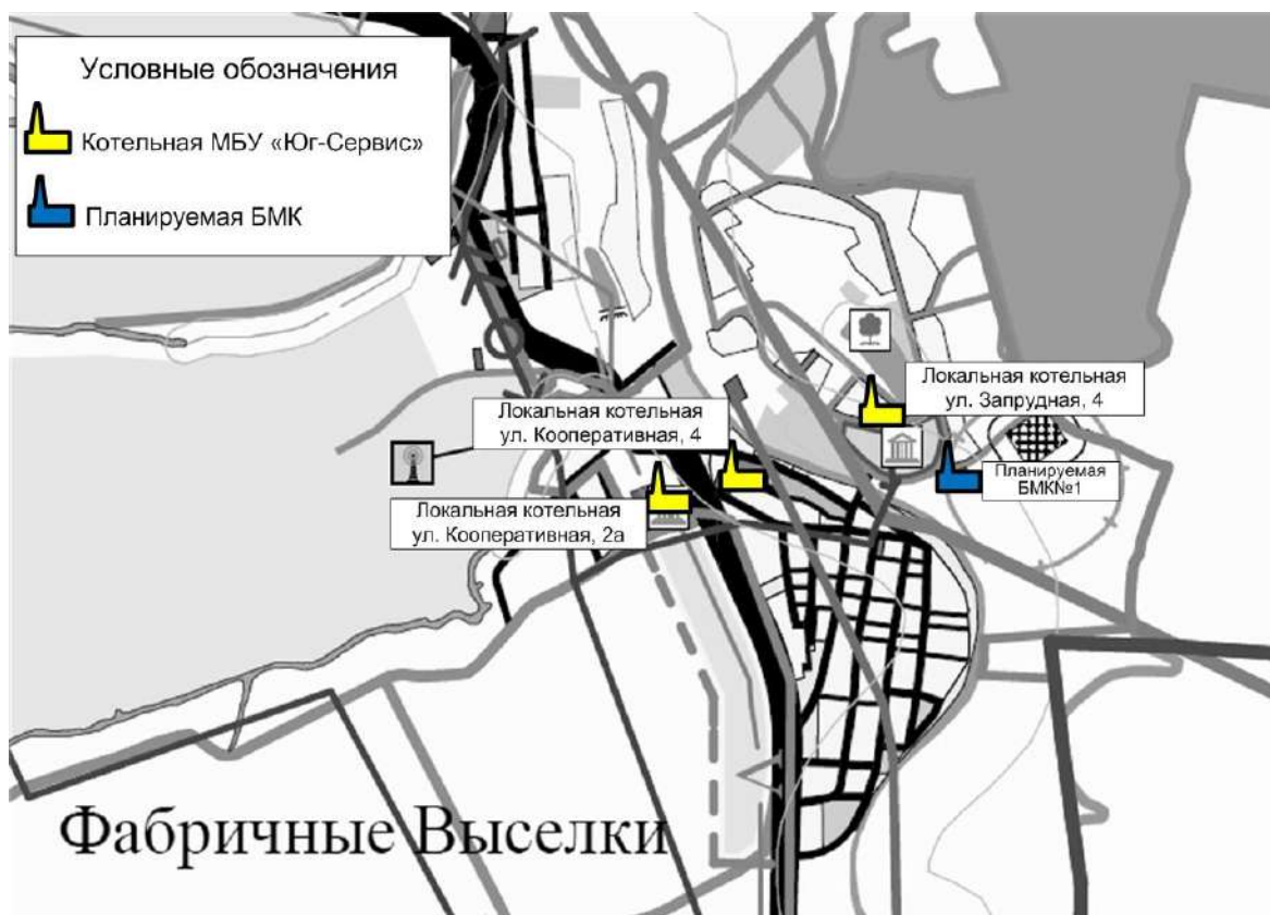
Рисунок 2.1.1 – Перспективные зоны теплоснабжения существующих локальных котельных и планируемого блочно-модульного источника тепловой энергии, действующих на территории п. Фабричные Выселки
